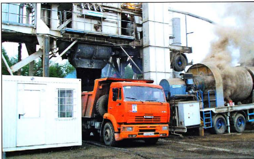
Завод по производству асфальта для реконструкции аэропорта «Магадан».
