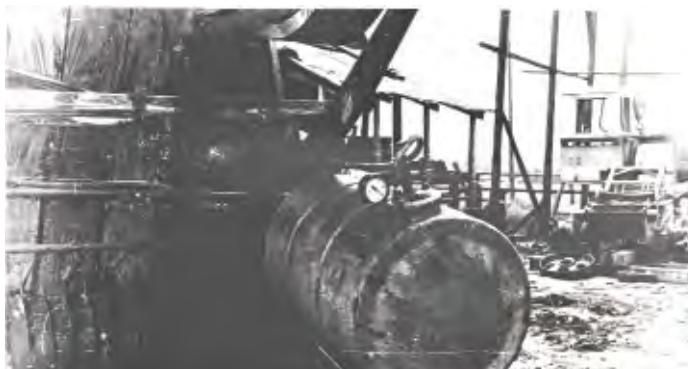
Установка для внесения жидких консервантов в прессованное сено
