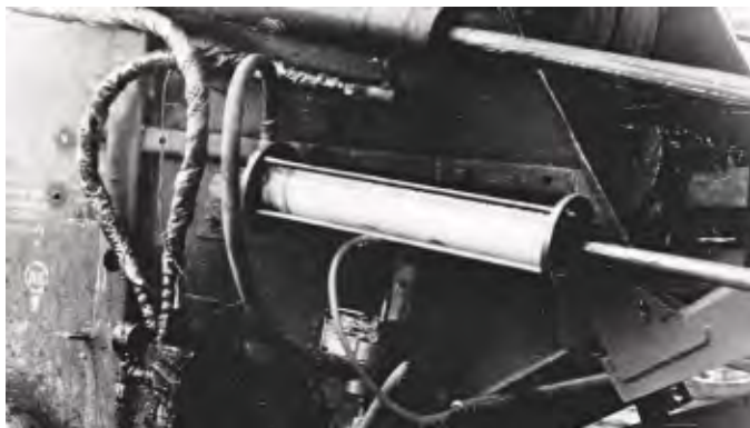
Приспособление для обработки сена консервантами при прессовании в рулоны (ПРП - 1,6)
