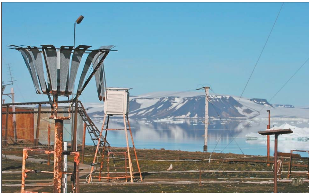
Осадкомер на метеостанции о.Хейса.
