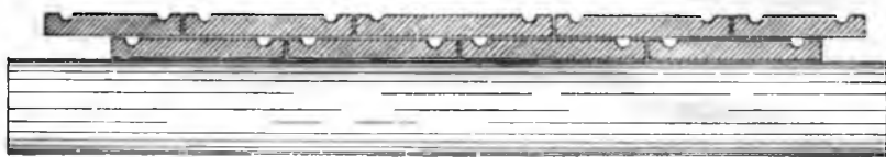
Рис. 27. Поперечный разрѣзъ части крыши въ „карту“.
