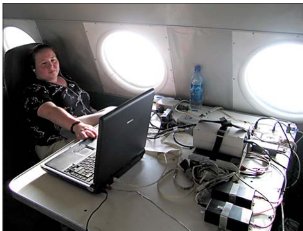
Рис. 29. Расположение регистрационного комплекса АМ-2М на борту самолета ИЛ-18Д.
