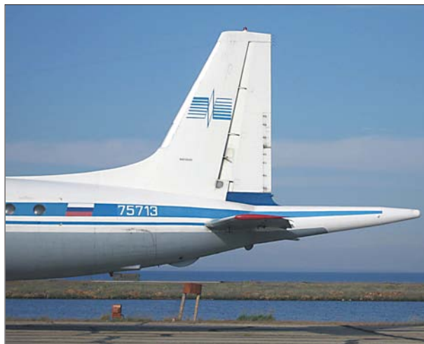
Рис. 28. Дооборудование самолета ИЛ-18 Д ХВОСТОВЫМ КОКОМ.
