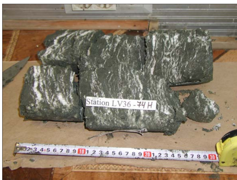
Рис. 10. Газогидратоносный интервал керна 40-68 см, станция LV36-74Н (очаг разгрузки газа Данжен).
