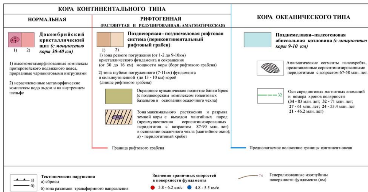
Рис. 4. Структурно-тектоническая схема бассейна моря Моусона.
