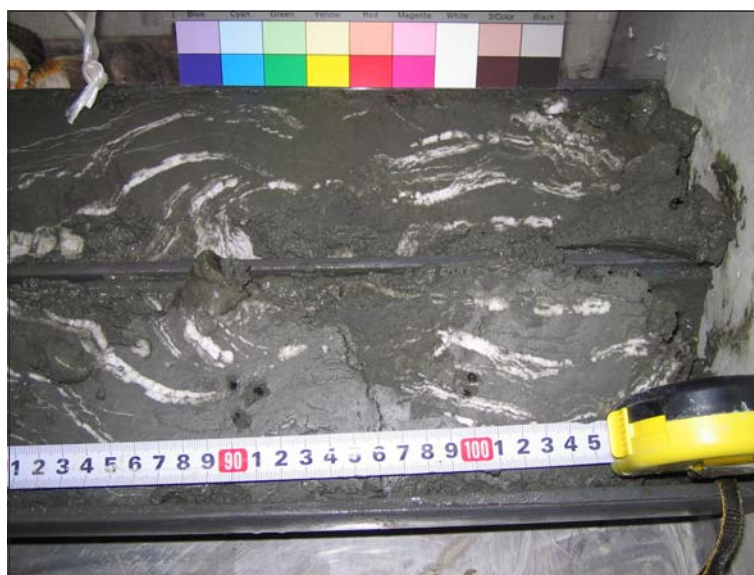
Рис. 7. Волнисто-субвертикальная гидратообусловленная текстура отложений, станция LV36-59Н (очаг разгрузки газа ВНИИОкеангеология).
