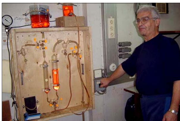
Рис. 18. Дегазационная установка для дегазации проб воды и донных осадков.
