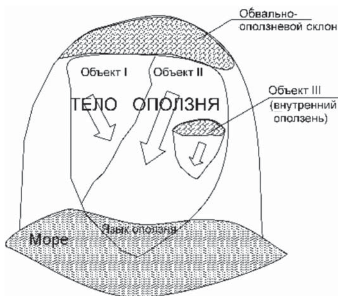
Рис. 17. Модель замкнутой геодинамической системы, созданная по результатам исследования оползневого полигона «Приветное».
