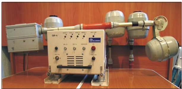
Рис. 27. Четырехканальный регистратор типа БИ-4 с датчиками МЧБ-1.
