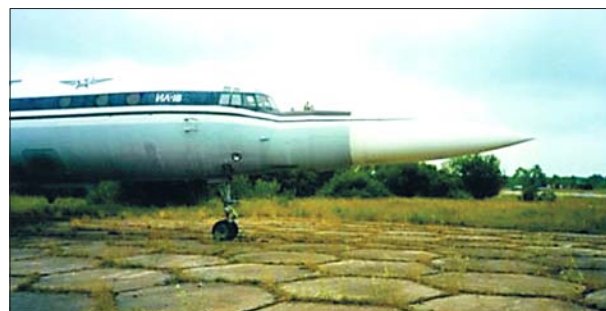
Рис. 24. Аэрогеофизический комплекс МАГНИТ, входящий в состав СЕЙСМОЛАБОРАТОРИИ ФГУП «ВНИИ-Океангеология».
