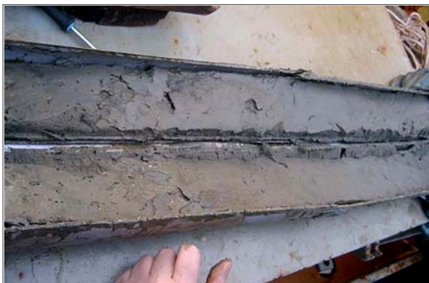
Рис. 15. Разрез донных отложений, отобранных гравитационной трубкой.
