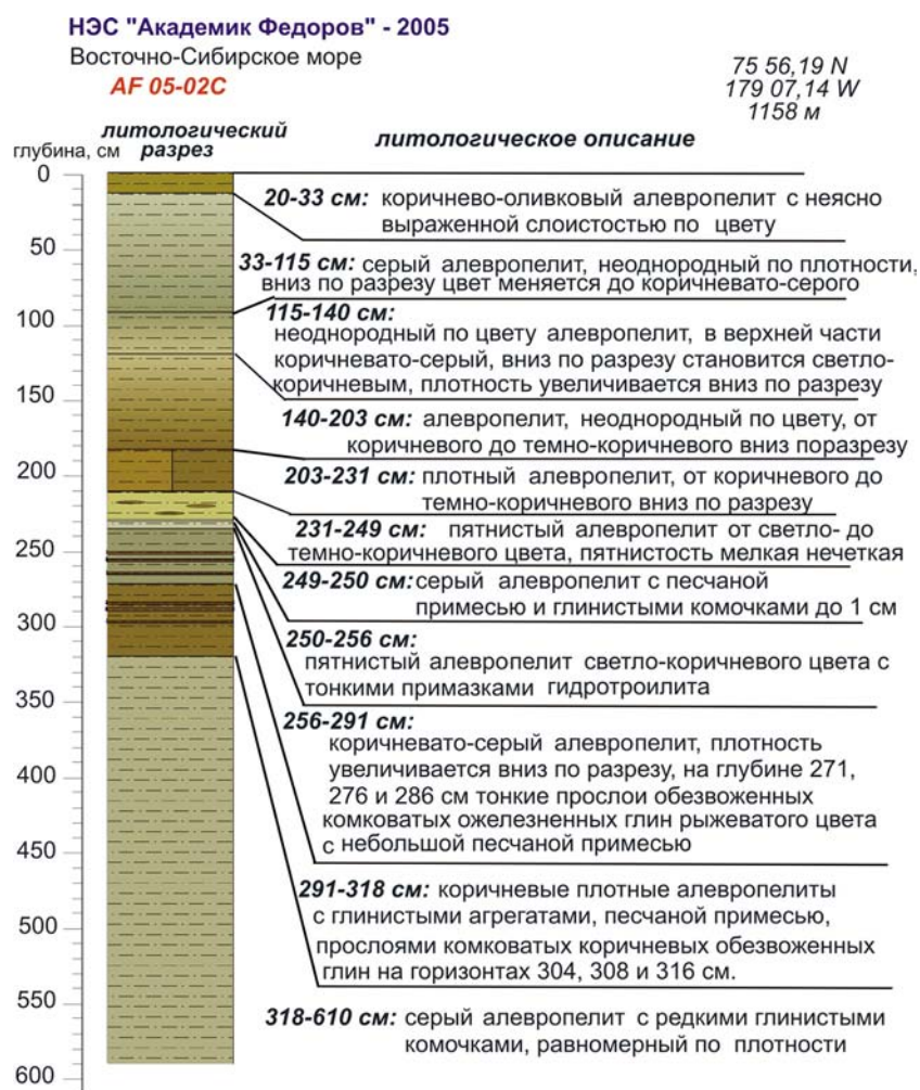
Рис.14. Литологический разрез и описание станции (ст. AF05-02C).
