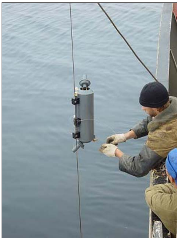
Рис. 18. Пятилитровый батометр для взятия проб придонной воды.
