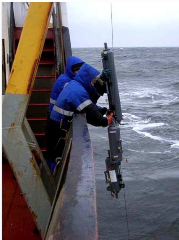
Рис. 17. 10-литровый батометр для опробования придонной воды.
