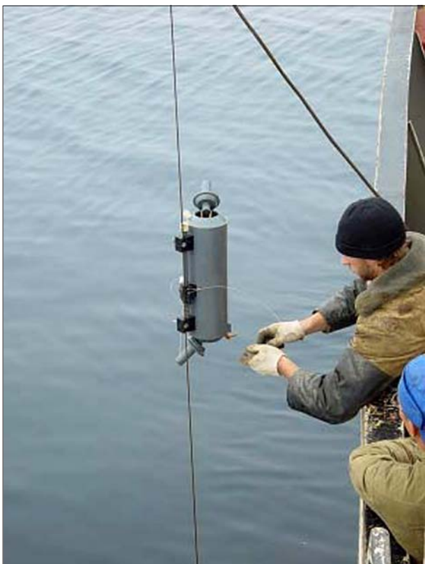
Рис. 16. 5-литровый батометр для взятия проб придонной воды.
