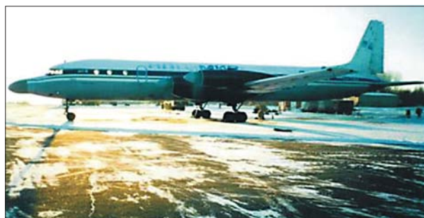
Рис. 25. Аэрогеофизический комплекс МАГНИТ на борту самолета типа ИЛ-18.
