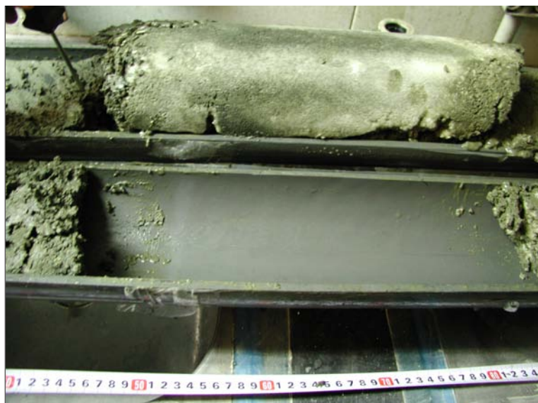
Рис. 6. Мощный слой газовых гидратов в интервале керна 48—82 см, станция LV36-39Н (очаг разгрузки газа КОПРИ).
