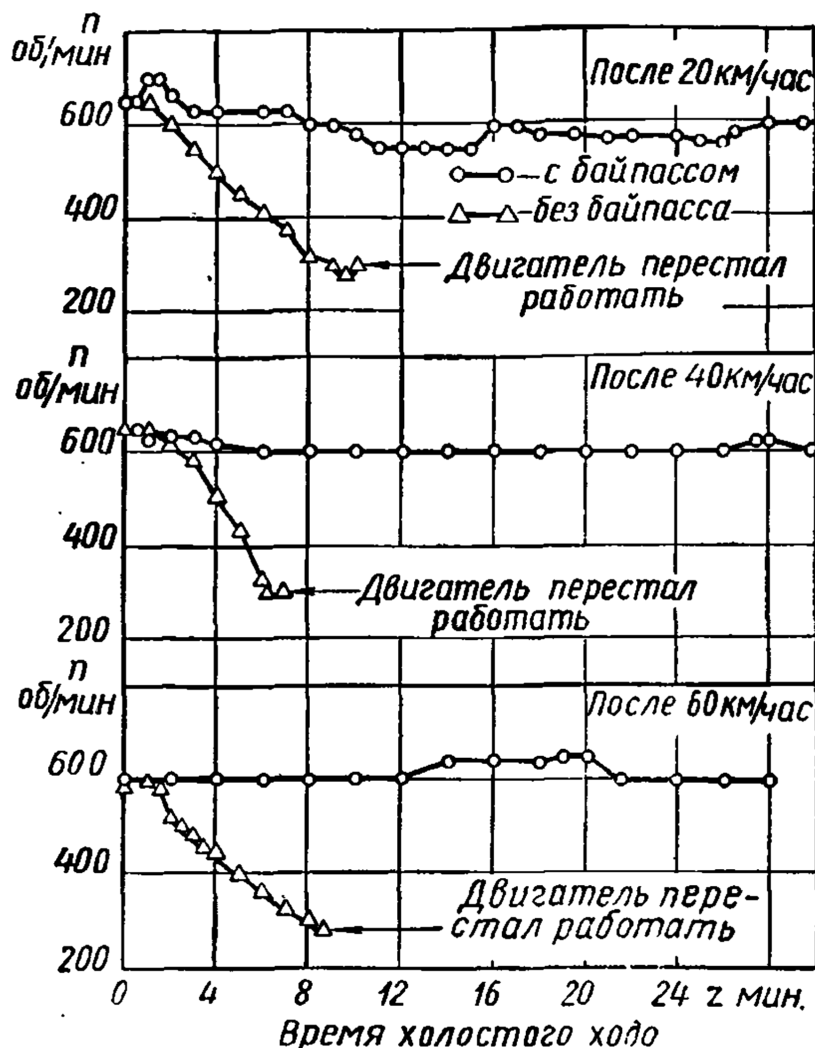
Фиг. 101. Изменение числа оборотов холостого хода двигателя ГАЗ-42 при работе с байпасом и без него на генераторном газе из древесных чурок.
