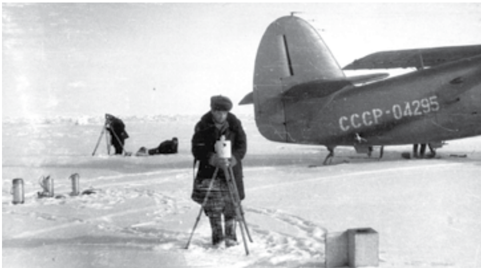
Авиадесантная магнитная и гравиметрическая съемка на льду Северного Ледовитого океана.
