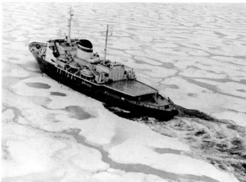
Фото 34. Дизель-электрический ледокол «Москва» прокладывает канал в припае
