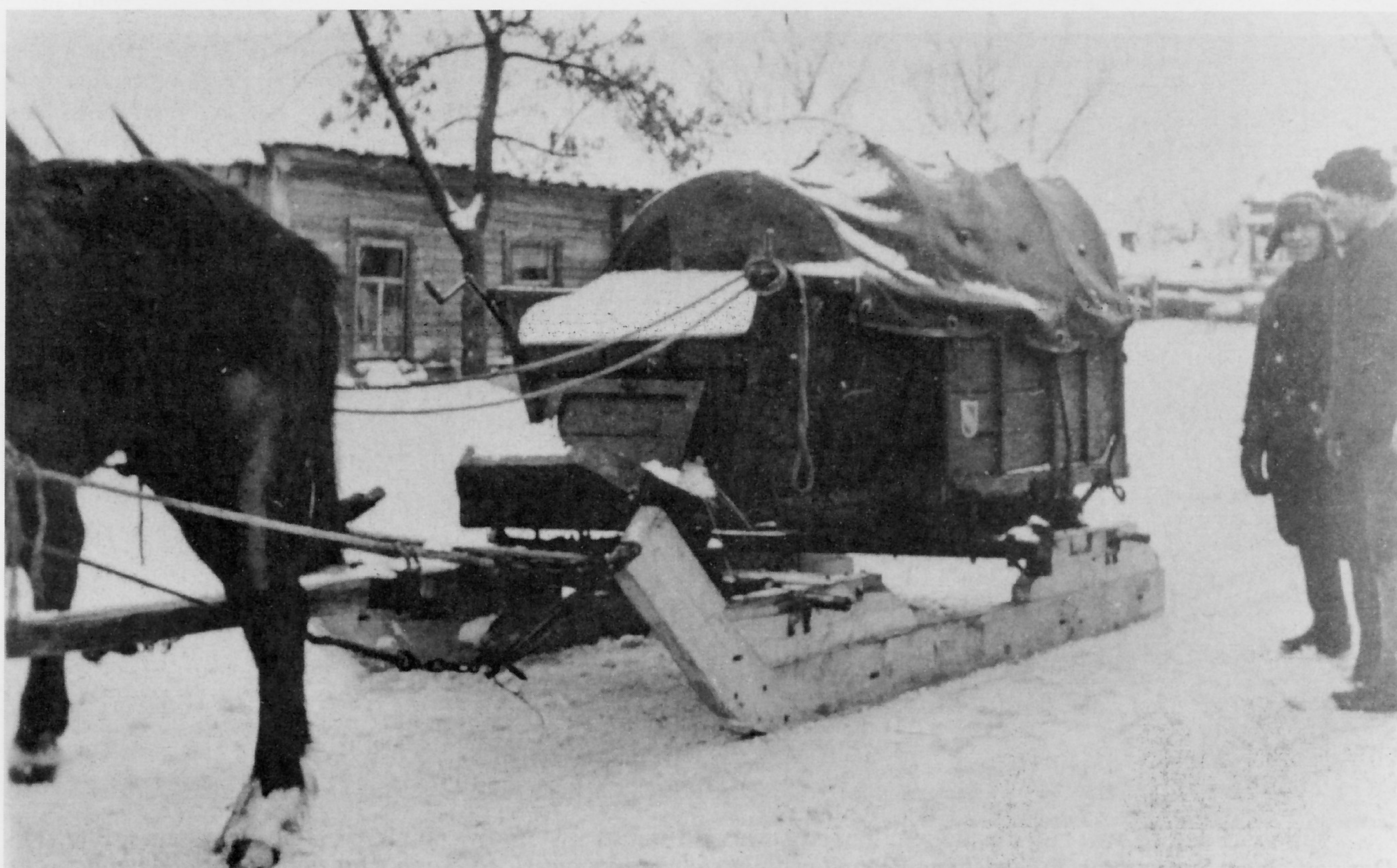
Eine besonders stabile Konstruktion stellte dieser schwere Pferdeschlitten dar, der im Merkblatt "Pionierdienst im Winter" von 1941 des OKH ausführlich beschrieben wurde und der u.a. auch über eine Feststellbremse verfügte
