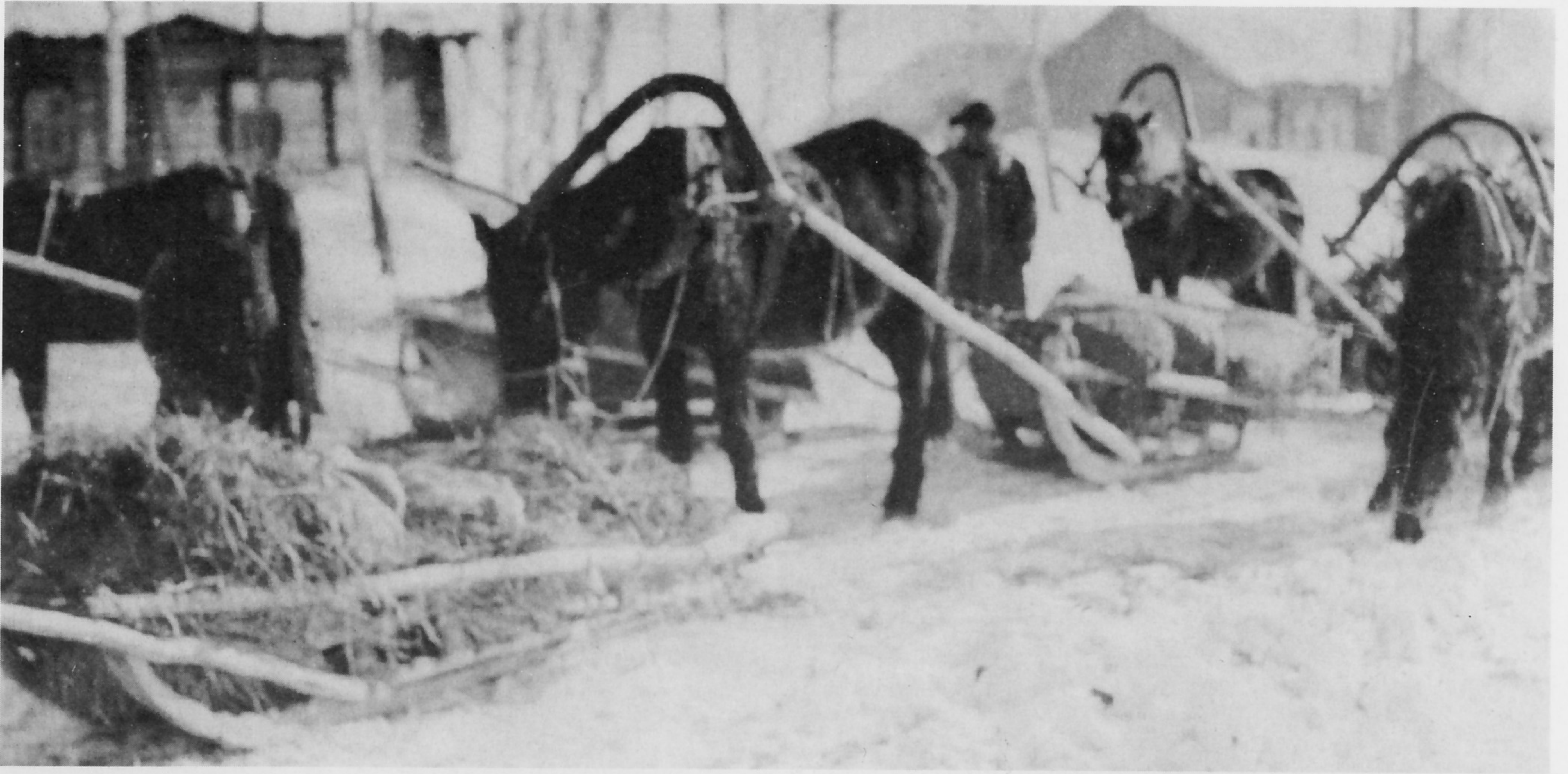
Sie zählten zu den einfachsten Transportmitteln im Winterkrieg - die Pferdeschlitten in Selbstbauweise. Sie waren ca. 2 m lang, 80 cm hoch und wurden im "Taschenbuch für den Winterkrieg" ausführlich beschrieben
