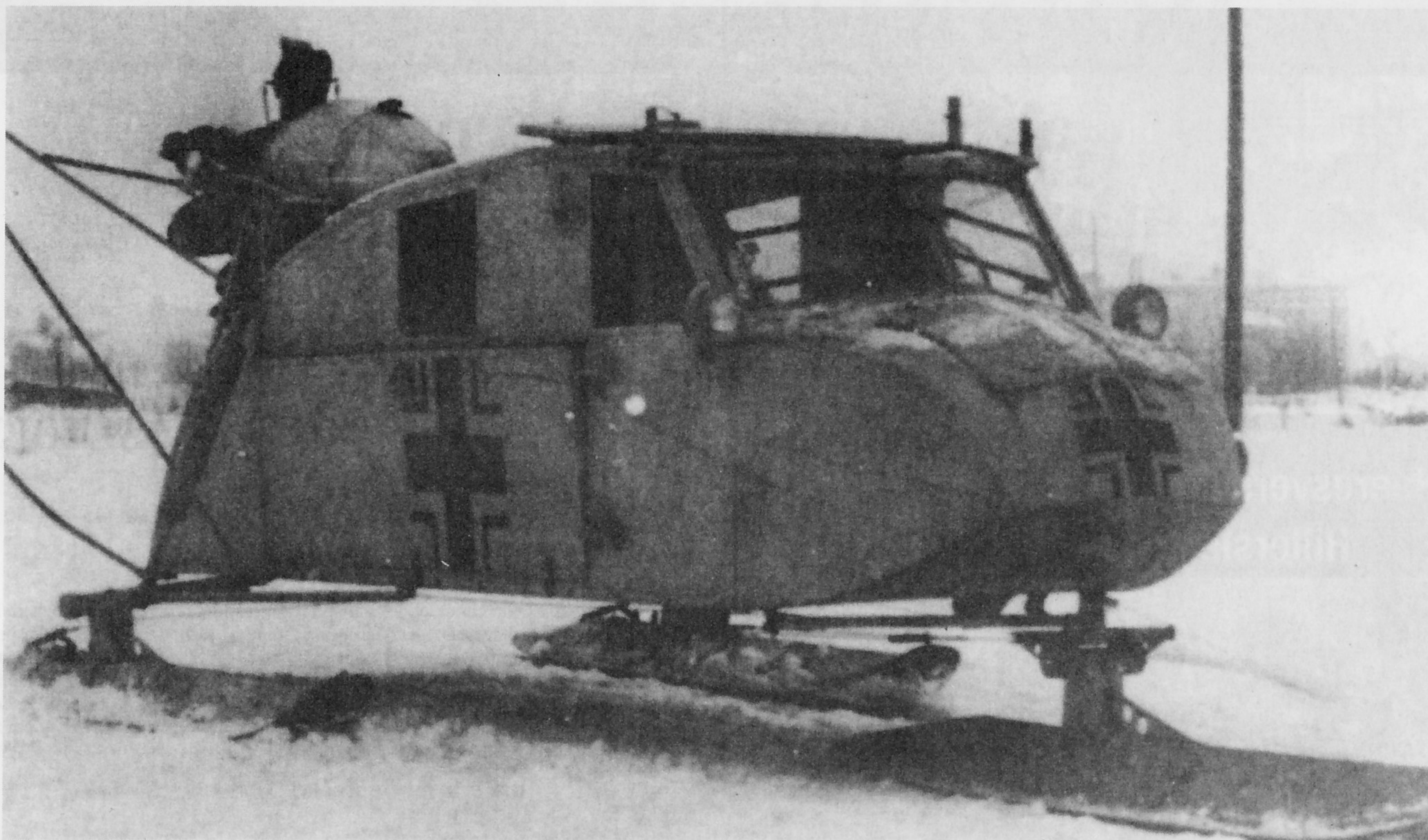
Die breiten Skikufen des Motorschlittens wurden vom Fahrer über einen Drahtseilmechanismus gesteuert. Das Führerhaus des Schlittens ähnelte dem eines Autos mit Lenkrad, Pedale und Armaturenbrett
