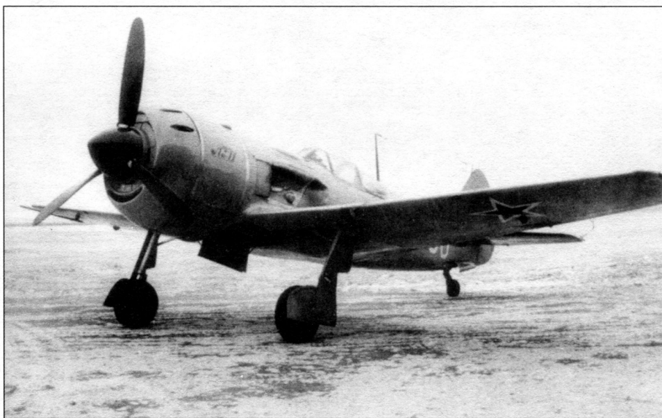
Серийный Ла-11 № 51210768 во время испытаний светотехнического оборудования
