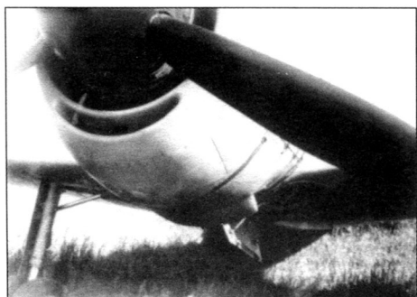
Маслорадиатор, вписанный в переднее кольцо капота, — характерная черта Ла-11
